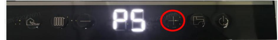
4. С помощью клавиш «+» и «-» выберите пункт меню «P5». Войдите в параметр нажав клавишу «Отопление» Затем с помощью клавиш «+» и «-» установите значение «30» и зафиксируйте выбор нажатием клавиши «Отопление»
