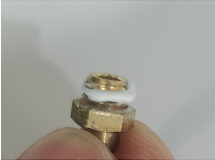
7. Установить новую форсунку с использованием герметика. Убедитесь после монтажа форсунки, что сопло не заблокировано излишками герметика.
